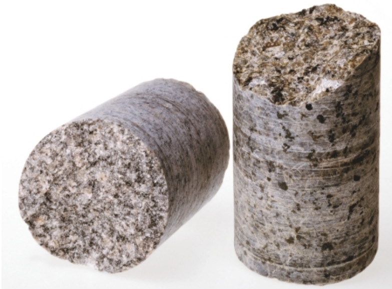
De to diamantborekerner fra henholdsvis "Sjælland" til venstre og "Skåne" til højre i billedet. Kernerne er ca. 10 cm i diameter. Foto: Peter Warna-Moors.
